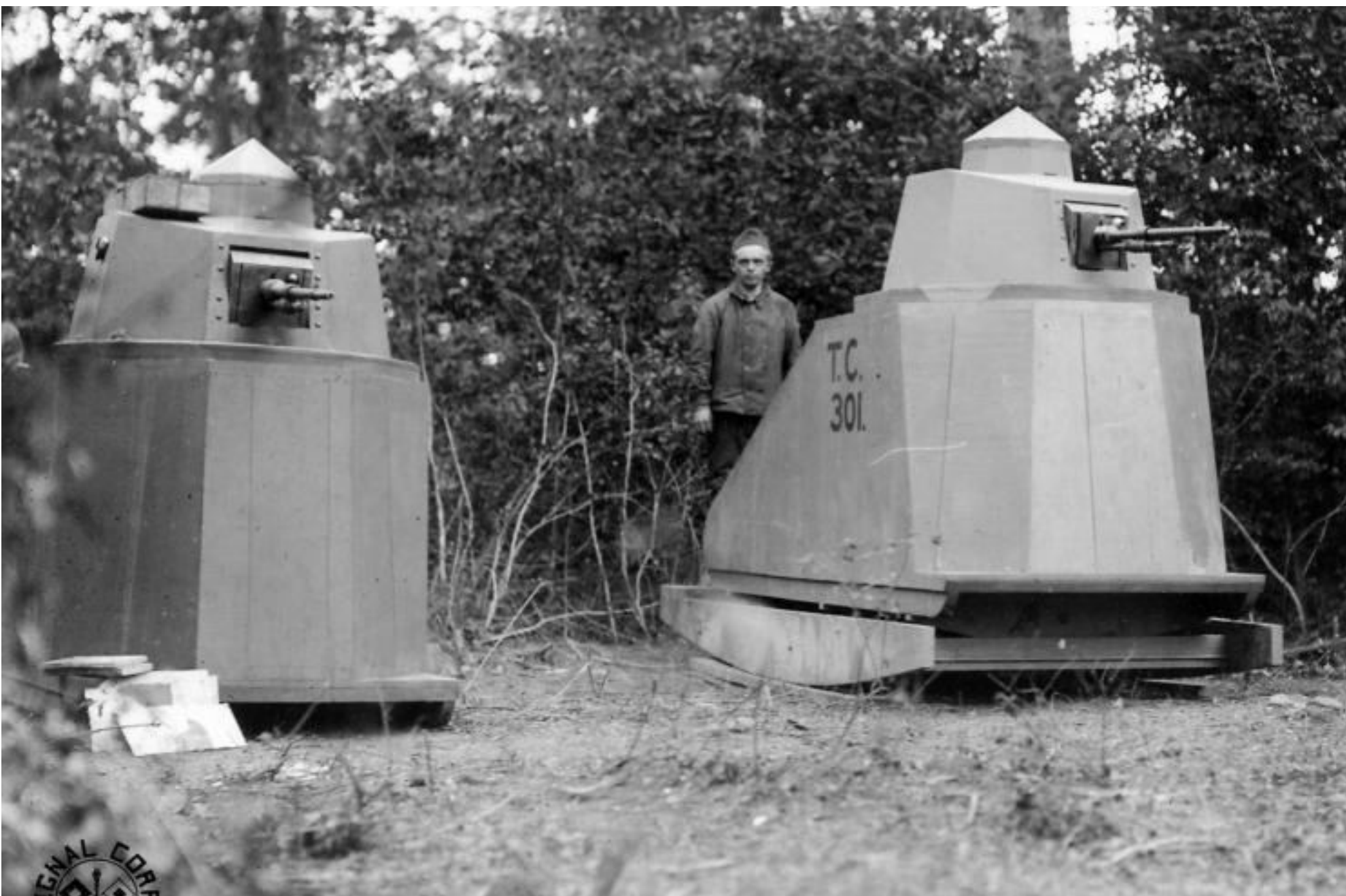
CHARS D'ENTRAINEMENT UTILISES POUR L'INSTRUCTION A L'UTILISATION DES MITRAILLEUSES. Le soldat à l'arrière saute sur le chassis à bascule pour reproduire les secousses ressenties dans un char.
