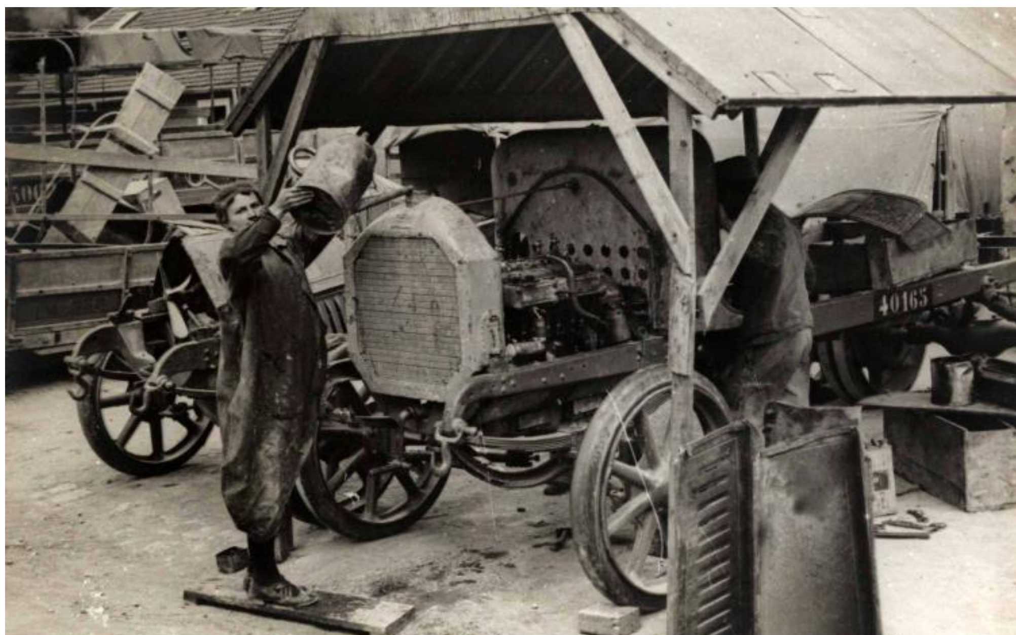
Bar-le-Duc. Parc d'armée (SP 9, 2 e armée). Femme remplissant le radiateur d'une voiture, avant l'essai du moteur. 1918. Source : Collections BDIC
