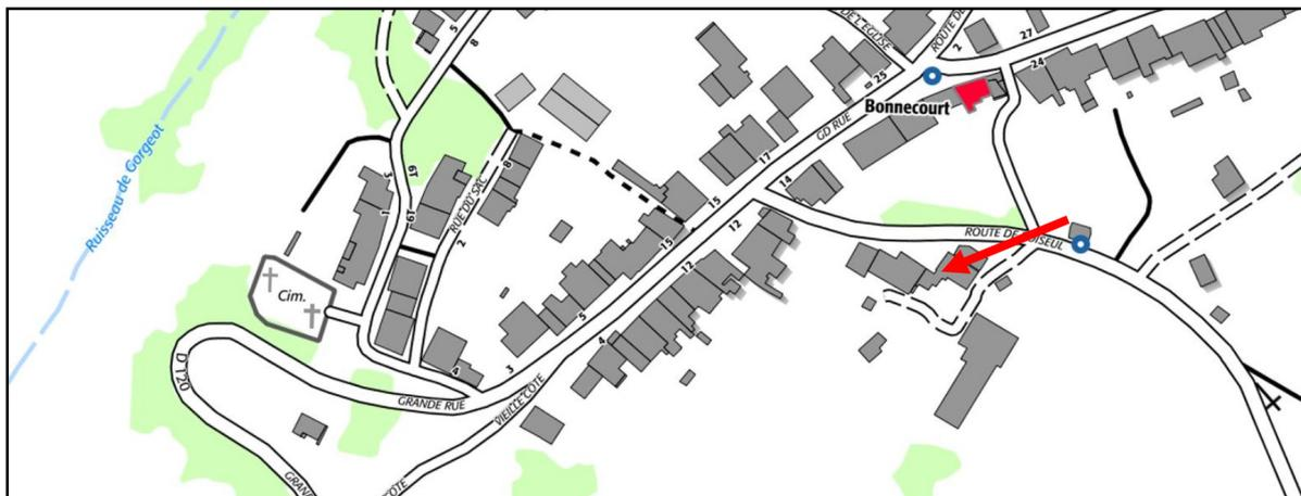
Altimétriquement, cette habitation n'est pas raccordable gravitairement, car le seuil de la porte d'entrée est bien inférieur à la cote radier du réseau de la grande rue. Actuellement, les effluents de cette habitation sont traités partiellement et rejetés à l'arrière de l'habitation dans un puisard.
